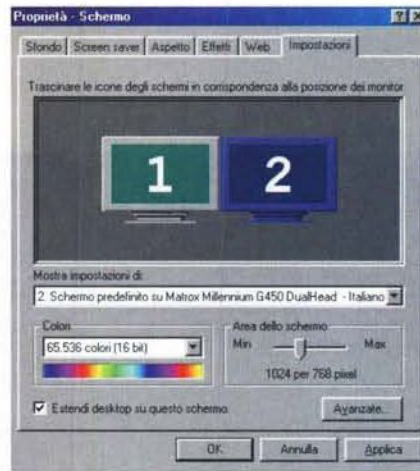
Driver Matrox, funzione Multi Desktop: con questa funzione è possibile estendere il desktop di Windows su due schermi separati, gestendo il DH attraverso una serie di scorciatoie da tastiera, tramite finestra di dialogo o direttamente con il driver video Matrox nella finestra proprietà dello schermo di Windows.
